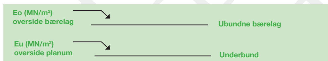
Figur 4 Pladebelastning på henholdsvis overside bærelag og overside planum.
